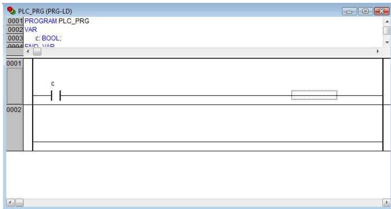
Рис. 19 Замыкающий контакт «с» и характерный прямоугольник» в конце цепи
